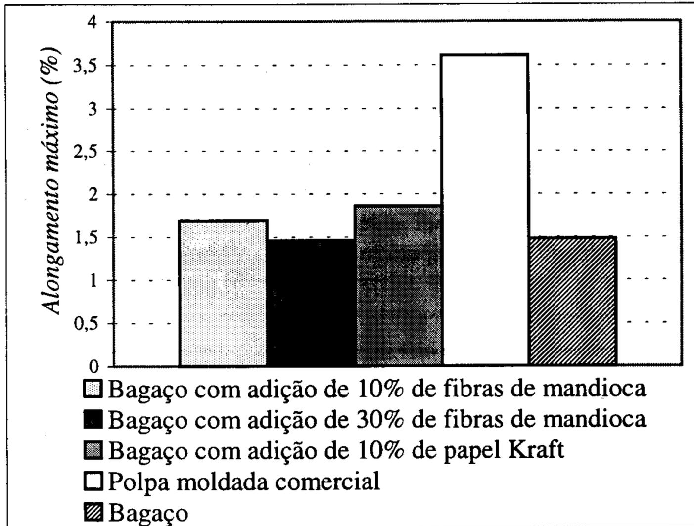
FIGURA 4 - Alongamento máximo na ruptura dos compósitos preparados e da polpa moldada comercial.
