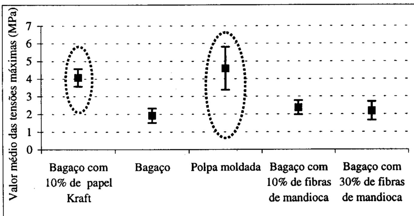
FIGURA 5 - Valor médio das tensões de ruptura, nos diferentes compósitos preparados.
