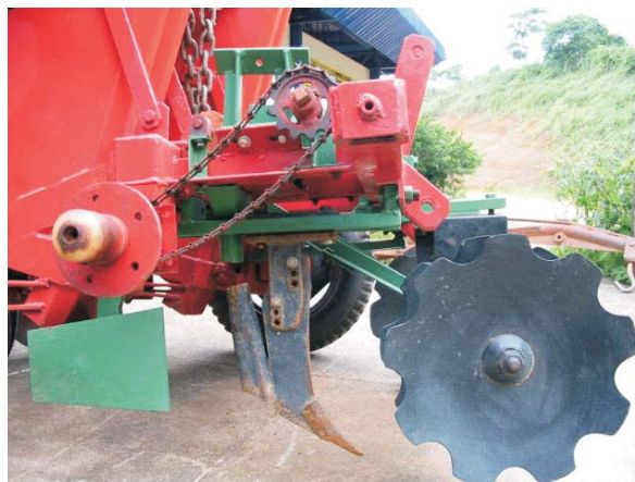
Figura 2 – Vista lateral do mecanismo adaptado à plantadora, mostrando conjunto de discos de grade, sulcador tipo bota e separador de adubo.
