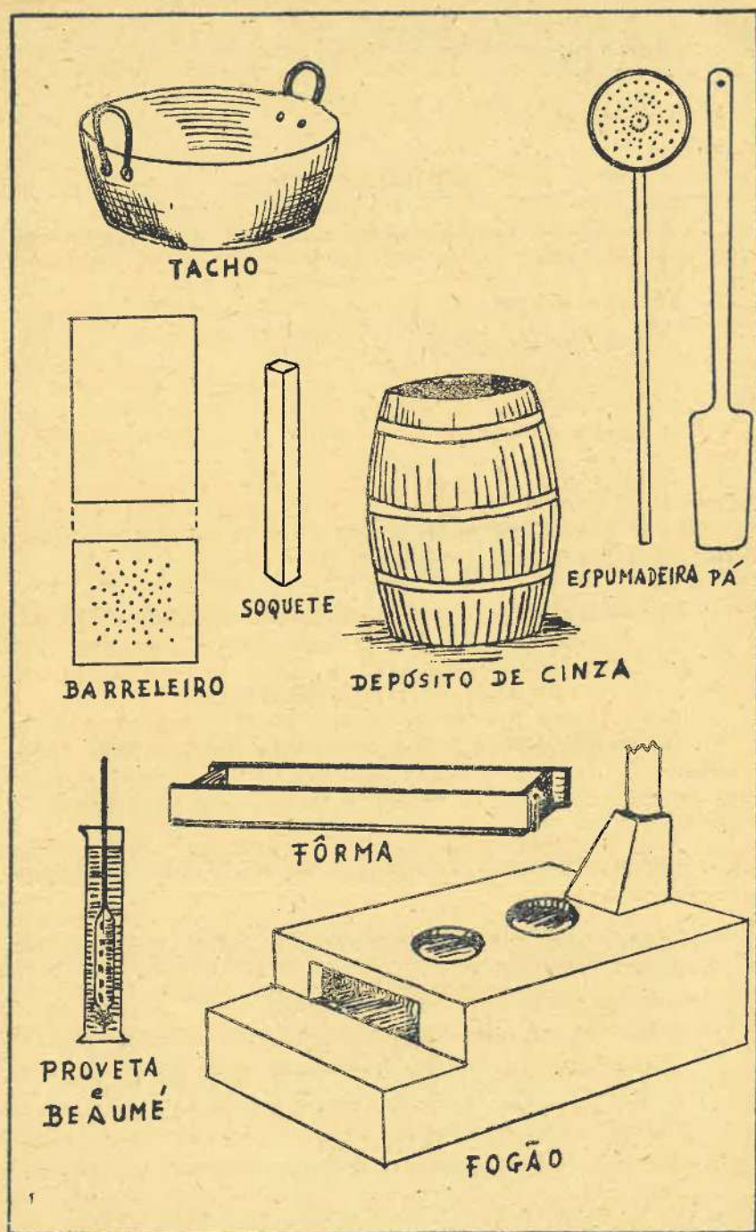
Fig. 1 — Material necessário á fabricação de sabão.
