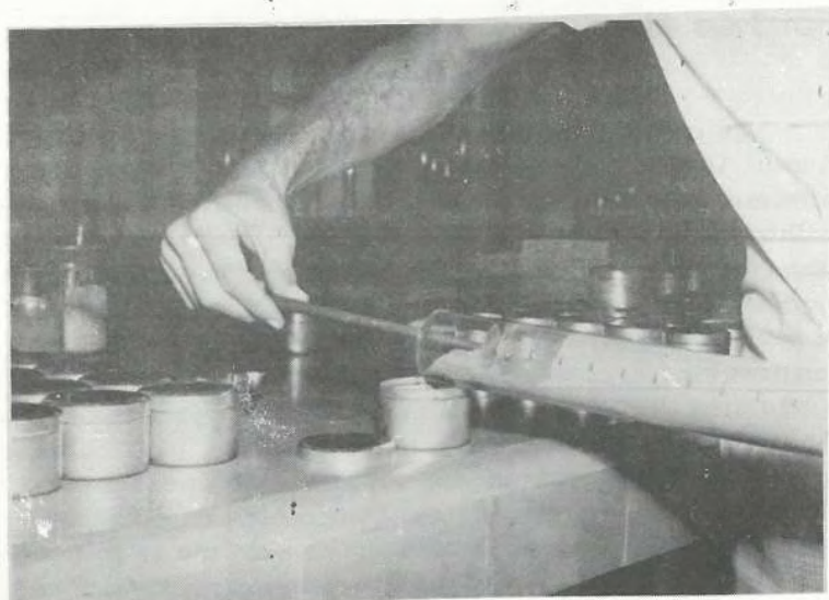
FIGURA 4 - Operação de Desmontagem das Colunas de Solo
