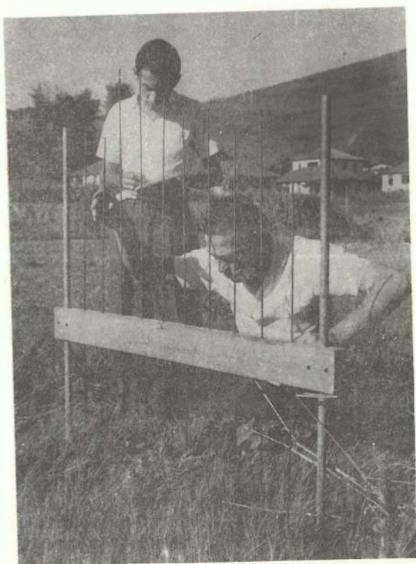
FIG. 1 - Aparelho "Point Analyser" usado para treinamento das estimativas visuais da composição botânica e produção de massa verde.
